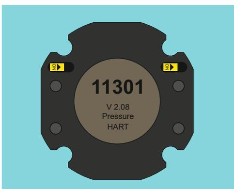
Después de identificar el sensor, mostrará el tipo de sensor, la versión de software, la clase y la tecnología del instrumento.
