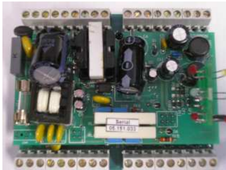
Figura A.1 – Vista superior do Multi-point (com uma chave de fenda, retire o parafuso)
