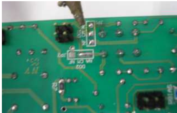
Figura A.4 – Com um ferro de solda e um sugador, retire o contato NA CM
