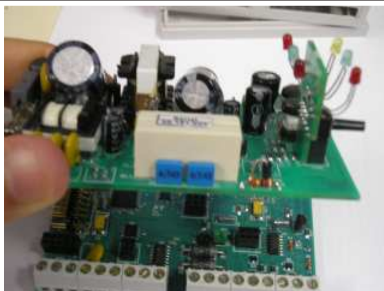
Figura A.2 – Retire a placa da fonte e relés
