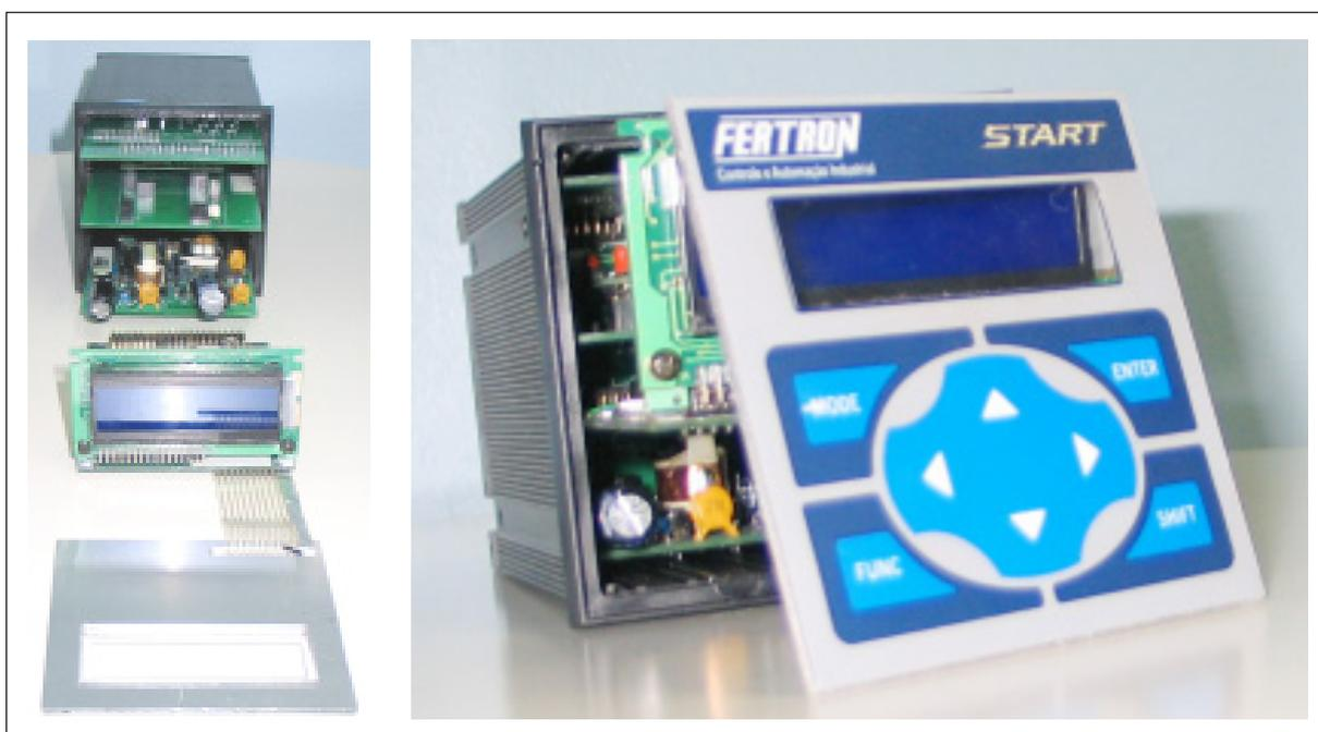
*Figura II.2 – Acesso aos módulos de expansão*
