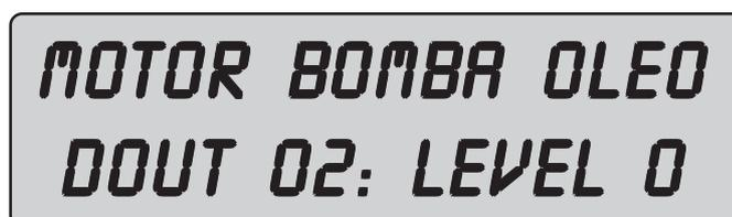
Figura III.15 – Visualização das saídas digitais no modo I/O Watch
