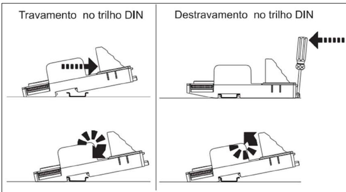
Figura 9 - Vista lateral de encaixe das bases no trilho DIN
